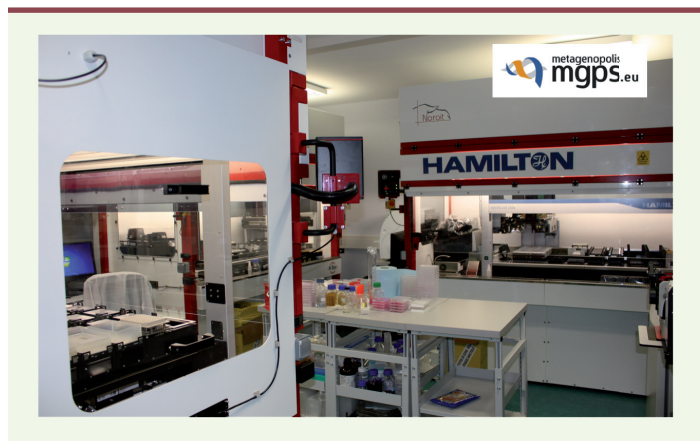
Figure 4. Plateforme robotique de métagenomique fonctionnelle de MétaGénoPolis. Cette photographie montre trois robots utilisés par l'unité MétaGénoPolis (INRA) pour réaliser les criblages à haut débit nécessaires à la métagenomique fonctionnelle.
